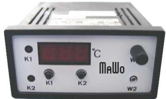
MAWO- DTR 3-Digitalregler sind benutzerfreundlich zu bedienende Regler mit 2 Schaltkontakten in platzsparender Bauform. Der Kontakt K1 dient als Regelkontakt, Kontakt K2 für Zusatzfunktionen wie Kühlung, Alarm etc. Die Ist-Temperatur wird dauernd digital angezeigt, die Sollwert-Temperaturen bei Drücken der Taster. Genaue Einstellung über Zehngangpotentiometer.
