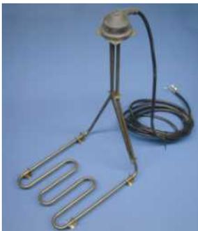
An dem Tauchbadwärmer wird ein Fühlerrohr mit einer Temperatursicherung angebracht. Das Anschlusskabel der Abdeckkappe hat zwei markierte Leitungen mehr, die auf Unterbrechung (z.B. mit dem Kontakt-schutzrelais) geprüft werden. Im Falle eines Trockenganges geht die Thermosicherung kaputt und dieser Stromkreis ist unterbrochen. Danach muss die Thermosicherung ausgetauscht werden. Passende Thermosicherungen können bei uns bezogen werden.
